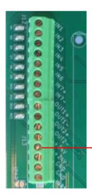
Analog AN3 Input Sensor 24 VDC
